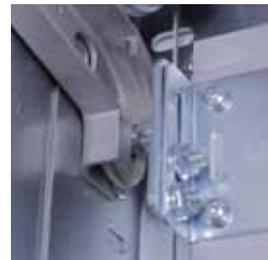
Rail C fermé verrouillant les galets
